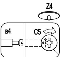
ориентация стяжки C5 - показана на рис, после сборки с дюбелем B4 стяжку затянуть по стрелке
